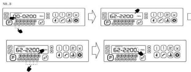
第四步：确认参数输入无误后，按住 $\mathcal{P}$ 键不动，直至操作面板红灯常亮或翁鸣器长响一声之后，松开 $\mathcal{P}$ 键，操作面板和整个系统即恢复到出厂设置状态。
