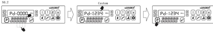
第三步：使用第一个和第二个 $+$ 键和 $-$ 键来改变技术员参数索引至【62】，使用后
