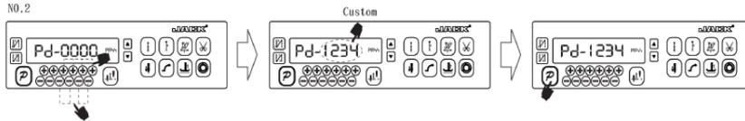
第三步：使用第一个和第二个 **+** 键和 **-** 键来改变技术员参数索引至 **【61】**，使用最后一个 **+** 键和 **-** 键更改恢复值，选“1”为下传参数，选“2”为上传参数。
