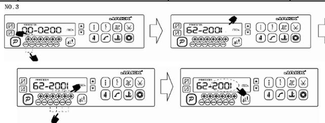
第四步：确认参数输入无误后，按住 **P** 键不动，直至操作面板红灯常亮或翁鸣器长响一声之后，松开 **P** 键，操作面板和整个系统即恢复到出厂设置状态。
