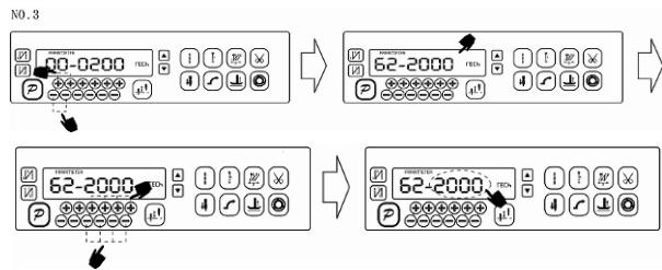
第四步：确认参数输入无误后，按住 $P$ 键不动，直至操作面板红灯常亮或翁鸣器长响一声之后，松开 $P$ 键，操作面板和整个系统即恢复到出厂设置状态。
